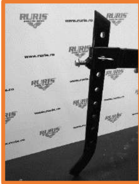
A mélységállító konzol és az eke a mellékelt csavarokkal van összekötve.
