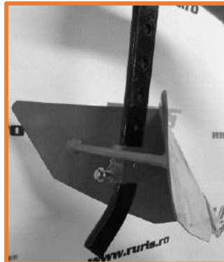
A mélységállító konzol és az eke a mellékelt csavarokkal van összekötve.
