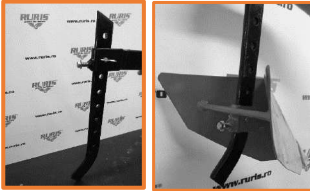
Konzola nastavenia hĺbky a pluh sú spojené pomocou dodaných skrutiek.
